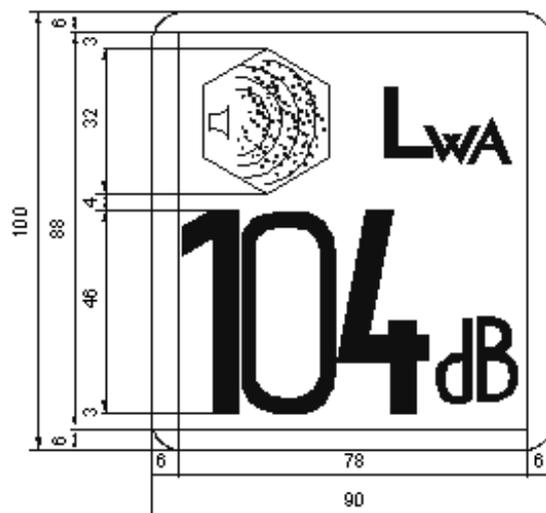
Se l'indicazione è ridotta o ingrandita ridotta a seconda delle dimensioni delle macchine o attrezzature, le proporzioni fornite nel disegno di cui sopra devono essere rispettate. La
