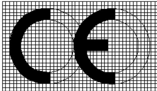
In caso di ingrandimento o di riduzione della marcatura CE a seconda delle dimensioni delle macchine o attrezzature, devono essere rispettate le proporzioni indicate nel grafico di cui sopra. I vari elementi della marcatura CE devono avere sostanzialmente la stessa dimensione verticale, che non può essere inferiore a 5 mm.
