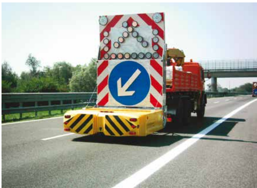
1. Un autocarro dotato d'attenuatore d'urto impiegato nell'ambito dei cantieri mobili
