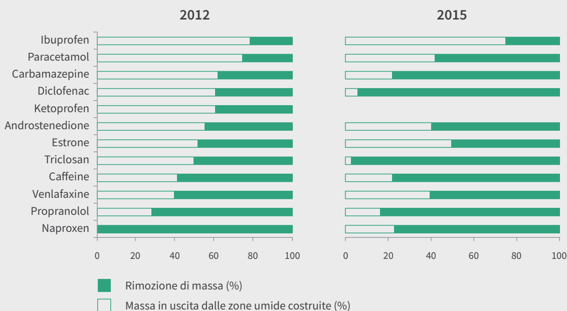
Figura | Tassi di rimozione dei diversi farmaci trovati in zone umide costruite artificialmente e operanti in diverse condizioni nel 2012 e nel 2015
